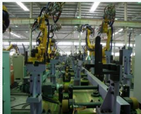
奇瑞165Kg点焊机器人及成线装备
