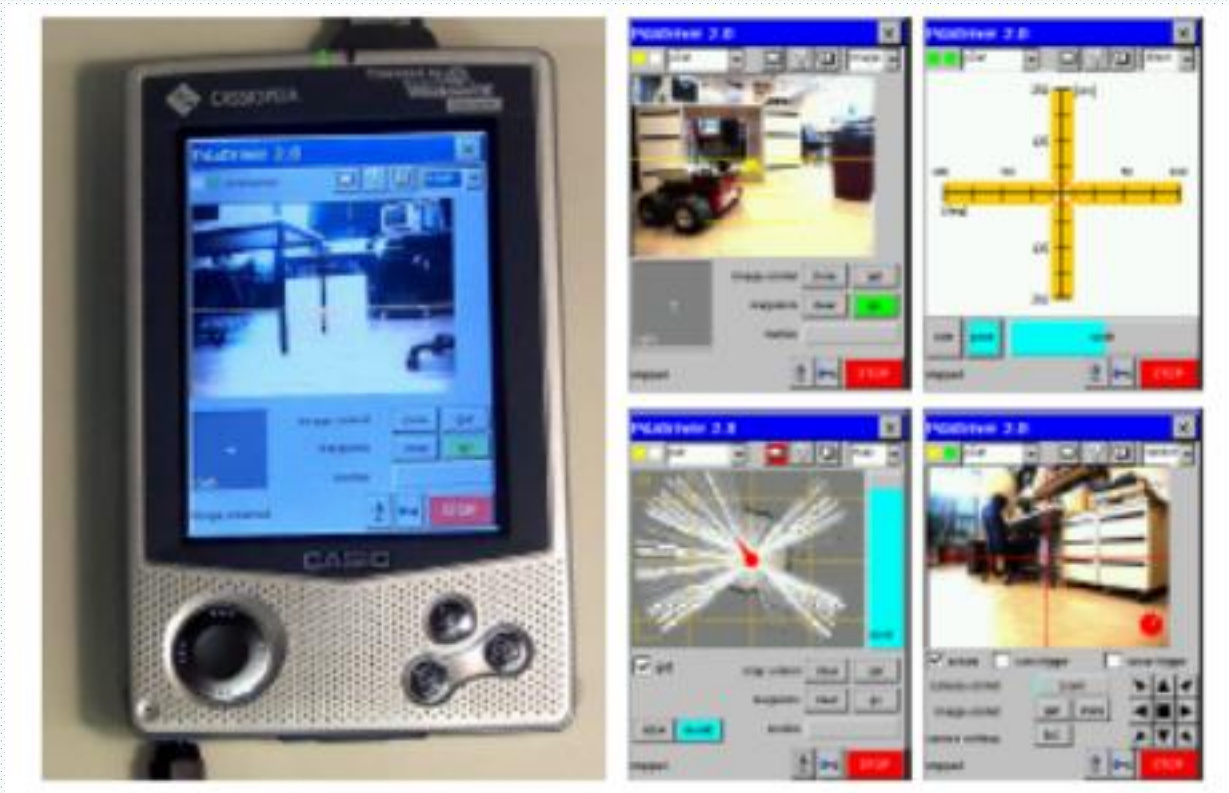
图：卡耐基梅隆大学和瑞士EPFL研制的机器人控制器 (采用卡西欧PDA和Windows CE)
